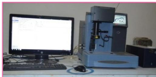
Fig. (5) Thermo Gravimetry Analyser
